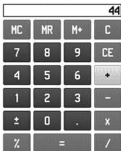
С помощью этой функции Вы можете использовать Ваш прибор eTrex Vista C как обычный калькулятор. С помощью меню опций Вы можете выбрать калькулятор со стандартным ("Standard") или расширенным ("Scientific") набором функций, а также определить единицы измерения угла -градусы ("Degrees") или радианы ("Radians").
